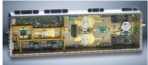
Figure 4 Transmit module
