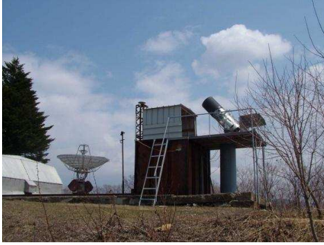
Figure 2. UN ORT telescope, 50 sm aperture, 3.5° x 3.5° FOV (Ussuriysk)
